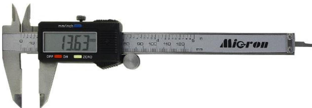
Рисунок 12 – Общий вид штангенциркулей модификации ШЦЦ-I
